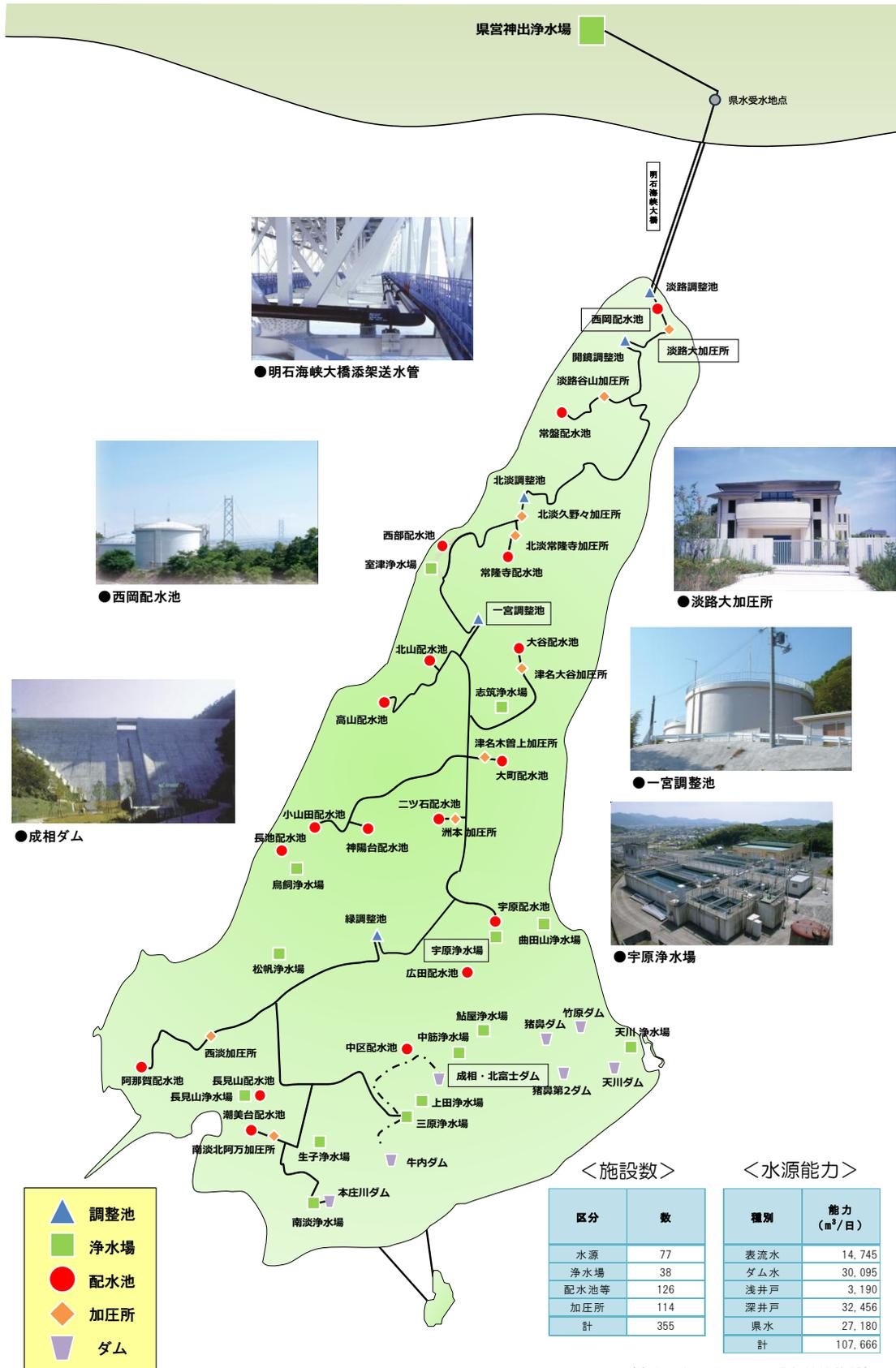
図 2.3.1 本企業団の主要な水道施設位置図、施設数及び水源能力
